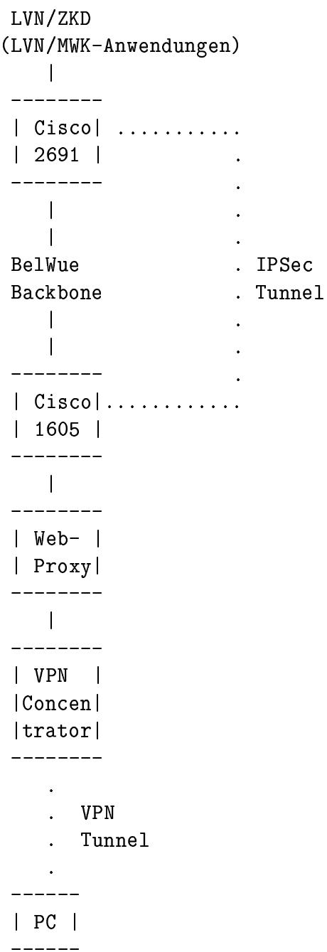
Der VPN-Tunnel wird hier von einem Arbeitsplatz-PC mittels der Cisco VPN Clientsoftware zu dem VPN Concentrator aufgebaut. Hierüber wird per http (TCP Port 80) der Web-Proxy angesprochen.
